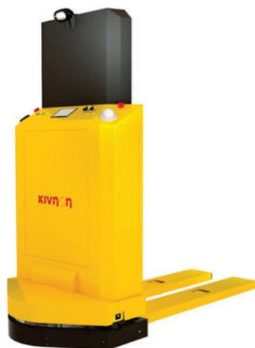
*Figura 6.5.5:* AGV modelo K55 de la empresa Kivnon, utilizado en el entorno real
