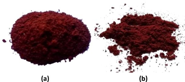
Figura 5.38. Aspecto de los pigmentos calcinados 1400°C/2h (a) y 1400°C/6h (b).
