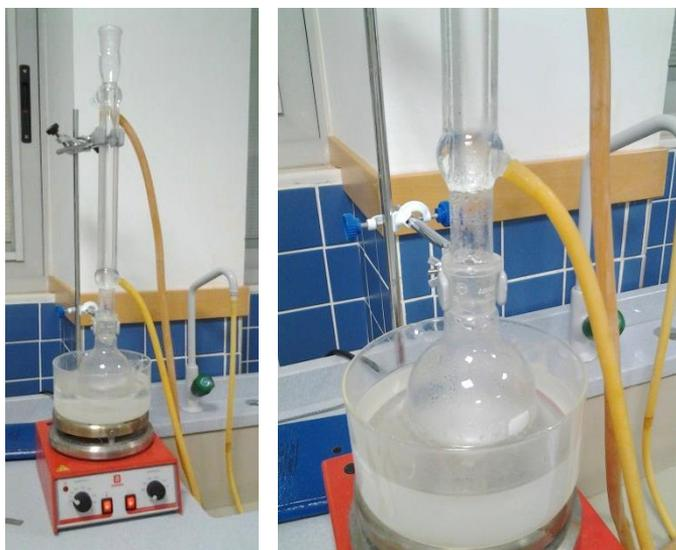
Figura 3.5. Sistema refrigerado de reflujo.
