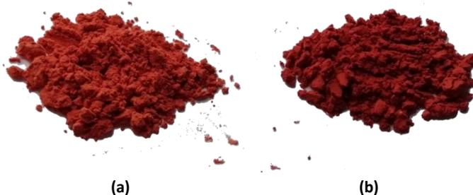
**Figura 4.49.** Aspecto de los pigmento  $Y_{0,98}Al_{0,98}Cr_{0,04}O_3$  calcinado a temperaturas de 1300°C/2h (a) y 1300°C/6h (b).
