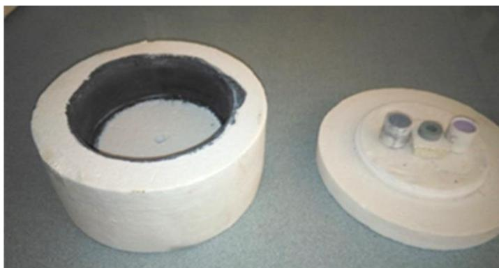
**Figura 3.8.** Cápsula para radiación microondas recubierta con SiC.
