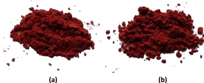
**Figura 4.50.** Aspecto de los pigmento  $Y_{0,98}Al_{0,98}Cr_{0,04}O_3$  calcinado a temperaturas de 1400°C/2h (a) y 1400°C/6h (b).
