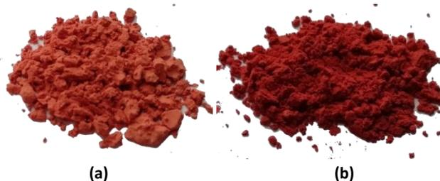
**Figura 4.48.** Aspecto de los pigmento  $Y_{0,98}Al_{0,98}Cr_{0,04}O_3$  calcinado a temperaturas de 1200°C/2h (a) y 1200°C/6h (b).
