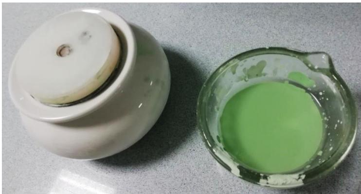
**Figura 3.1.** Aspecto de mezcla de óxidos homogeneizados en molino planetario de bolas.
