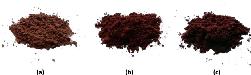
**Figura 4.31.** Aspecto de los pigmento  $Y_{0,98}Al_{0,98}Cr_{0,04}O_3$  calcinado a temperaturas de 1300°C (a), 1400°C (b) y 1500°C (c).
