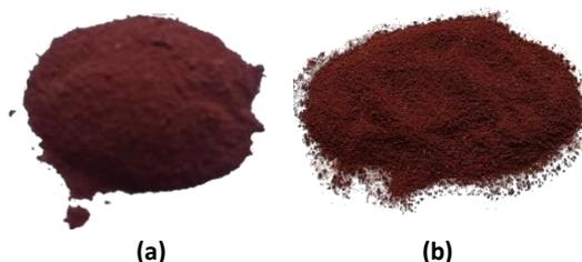
**Figura 5.19.** Aspecto de los pigmento  $Y_{0,98}Al_{0,98}Cr_{0,04}O_3$  calcinado a temperaturas de 1300°C (a) y 1400°C (b) empleando 5% de  $CaF_2$ .
