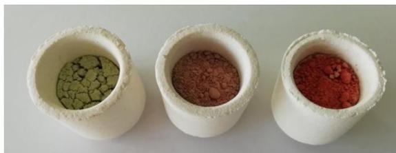
**Figura 3.9.** Ejemplo de pigmentos sintetizados por radiación microondas.
