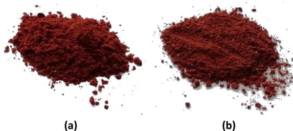
Figura 5.36. Aspecto de los pigmentos calcinados a 1200°C/2h (a) y 1200°C/6h (b).
