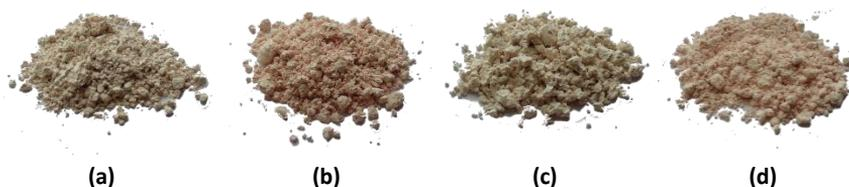
**Figura 4.58.** Aspecto de los pigmentos calcinados a  $1400^{\circ}\text{C}$  con un tiempo de permanencia de 6 horas a máxima temperatura, sintetizado Vía Tradicional mediante mineralizadores amónicos. 5%  $\text{NH}_4\text{Cl}$ -5%  $\text{NH}_4\text{NO}_3$  (a), 10%  $\text{NH}_4\text{NO}_3$  (b), 10%  $\text{NH}_4\text{Cl}$  (c), 5%  $\text{NH}_4\text{NO}_3$  (d).
