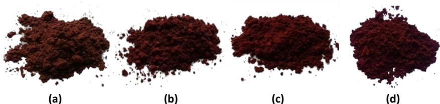
Figura 4.5. Aspecto de los pigmentos  $Y_{0,99}AlCr_{0,01}O_3$  (a),  $Y_{0,97}AlCr_{0,03}O_3$  (b),  $Y_{0,95}AlCr_{0,05}O_3$  (c) y  $Y_{0,90}AlCr_{0,10}O_3$  (d).
