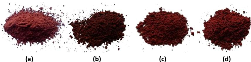
**Figura 4.11.** Aspecto de los pigmentos  $YAl_{0,99}Cr_{0,01}O_3$  (a),  $YAl_{0,97}Cr_{0,03}O_3$  (b),  $YAl_{0,95}Cr_{0,05}O_3$  (c) y  $YAl_{0,90}Cr_{0,10}O_3$  (d).
