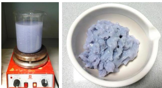
**Figura 3.6.** Formación de la coprecipitación homogénea de hidróxidos en forma coloidal.
