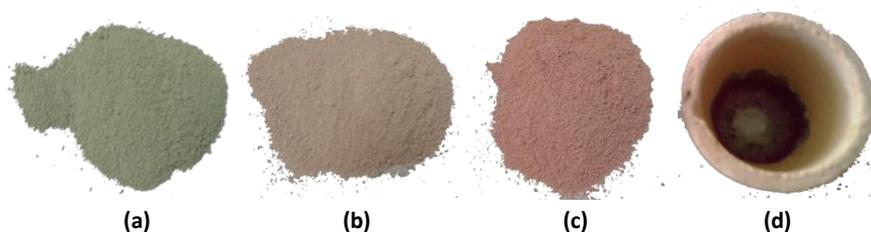
**Figura 5.9.** Aspecto de los pigmento  $Y_{0,98}Al_{0,98}Cr_{0,04}O_3$  calcinado a temperaturas de 1200°C (a), 1300°C (b), 1400°C (c) y 1500°C (d) sin mineralizador.
