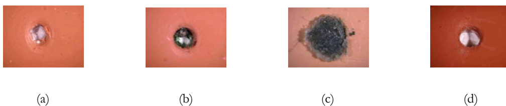
Figura VI 22. Vista exterior de los goteros (a) inicialmente y al final del lateral al cabo de 750 h de funcionamiento (b) con el efluente secundario filtrado en un filtro de malla de 130 µm (c) con el efluente secundario filtrado en un filtro de anillas de 130 µm y (d) con el efluente terciario filtrado en un filtro de malla de 130 µm.
