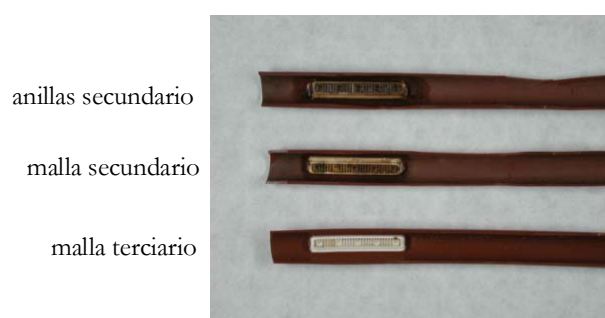
Figura VI 23. Vista de una sección de los laterales y emisores de las diferentes subunidades situados a 2/3 de la longitud al finalizar el ensayo.
