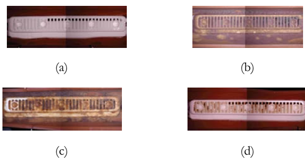
Figura VI 20. Estado interior de los goteros (a) inicialmente y a un 1/3 del lateral al cabo de 750 h de funcionamiento (b) con el efluente secundario filtrado en un filtro de malla de 130 µm (c) con el efluente secundario filtrado en un filtro de anillas de 130 µm y (d) con el efluente terciario filtrado en un filtro de malla de 130 µm.
