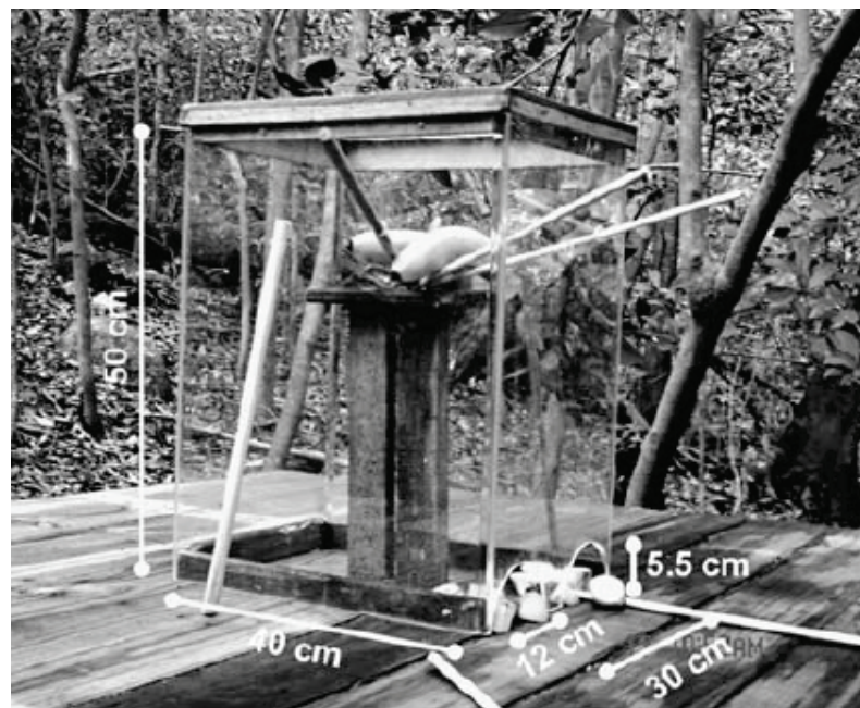
Figura 22: Caja de plexiglás con pasadores utilizada en el experimento de campo sobre lateralidad manual de Garber et al.(2008) con Cebus .
