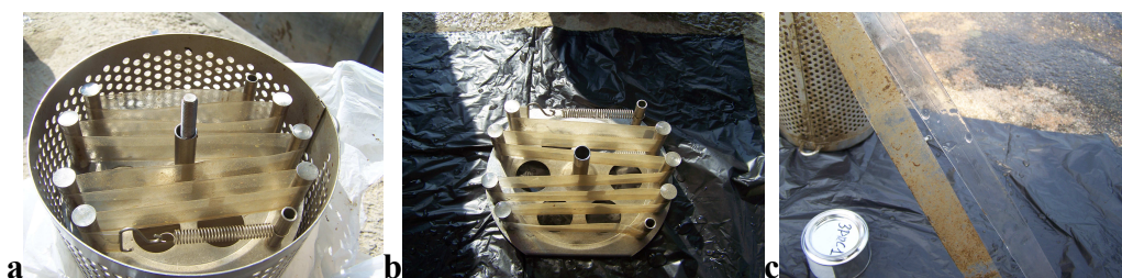
Figura. 6. SPMDs. A) SPMDs dins el canister. B) spider amb la membrana SPMD. C) comparació de les membranes sortint del sistema fluvial amb les membranes netejades abans del magatzem pel laboratori.
