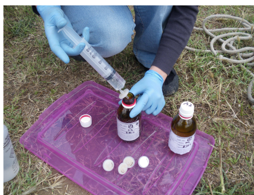
Figura 2. Mostreig d'aigua fluvial total i aigua filtrada en envasos de vidre àmbar
