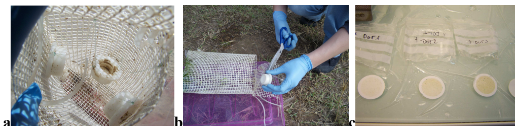
Figura 4. Imatges del mostreig amb DGTs. a i b) retirada dels DGTs del sistema fluvial. c) processament dels DGTs al laboratori.
