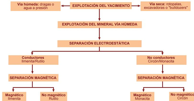
Figura 2.15 Proceso general de obtención de la arena de circón.
