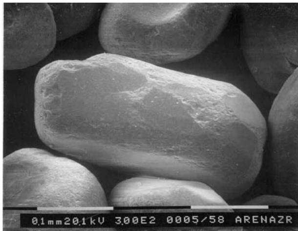
**Figura 2.13** *Partículas de circón observadas mediante microscopio electrónico de barrido.*
