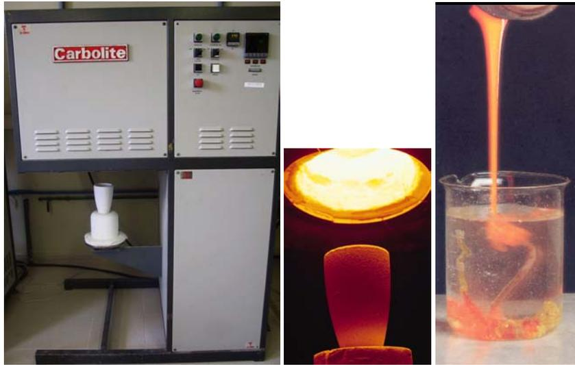
**Figura 4.9** De izquierda a derecha: Horno de fusión, crisol a la  $T_{m\acute{a}x}$  y vertido de la masa fundida en agua.
