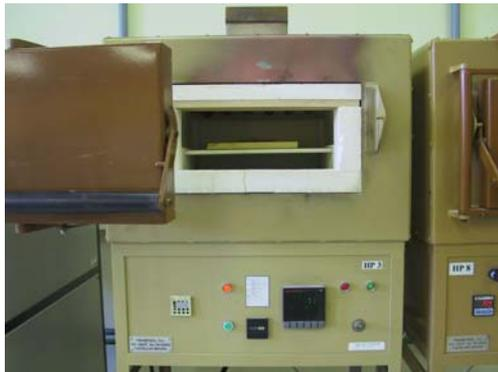
**Figura 4.7** Horno eléctrico de laboratorio para la cocción de piezas cerámicas.
