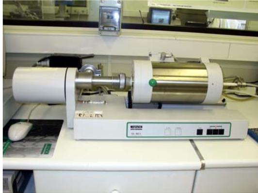
**Figura 4.10** Dilatómetro. Equipo para la determinación de la curva de expansión térmica.
