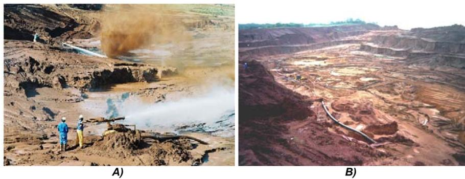
Figura 2.17 Explotación del yacimiento vía húmeda mediante proyección de agua a presión (Sudáfrica). A) Sistema de proyección de agua. TICOR. Fuente: [www.ticor.com.au](http://www.ticor.com.au). B) Transporte de la suspensión mediante conducciones.
