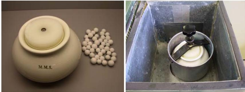
**Figura 4.4** Jarra, bolas de alúmina y molino rápido de laboratorio.
