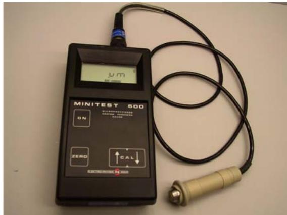
**Figura 4. 12** Medidor de espesor.
