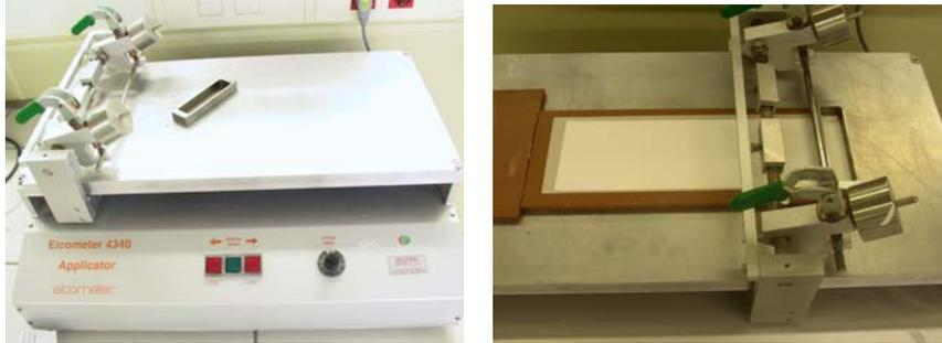
**Figura 4.5** *Equipo para la aplicación de suspensiones de esmalte sobre el soporte cerámico. Izquierda: Equipo y recipiente para la aplicación. Derecha: Pieza resultante de la aplicación de la suspensión.*
