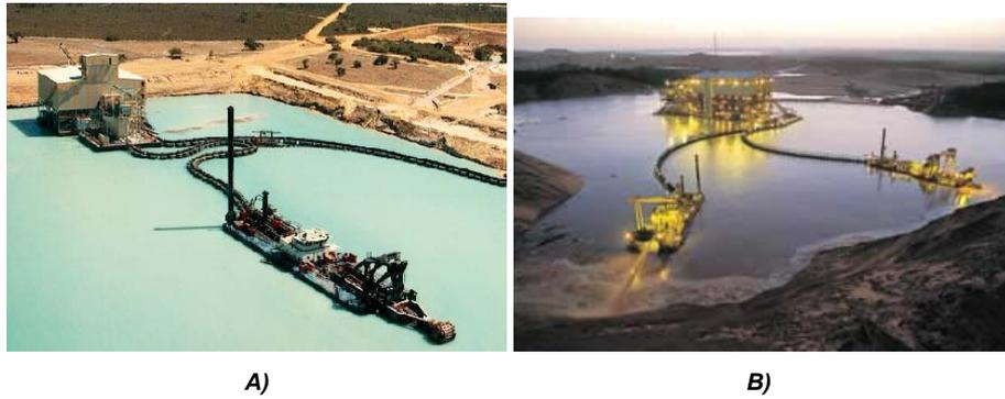
Figura 2.16 Explotación del yacimiento vía húmeda. A) Dragado. TIWEST (Cooljarloo, Western Australia). Fuente: [www.ticor.com.au](http://www.ticor.com.au) 31/05/04. B) Proyección de agua a presión y posterior dragado. Richards Bay Minerals. Sudáfrica. Fuente: [www.riotinto.com](http://www.riotinto.com) 27/05/04.
