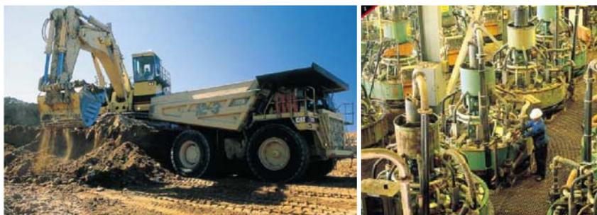
**Figura 2.28** Métodos utilizados por la empresa Namakwa Sands para la extracción (Izquierda) y beneficiación del circón (Derecha: separador magnético de alta intensidad en húmedo). Fuente: Namakwa Footprints 2002. [www.angloamerican.co.uk](http://www.angloamerican.co.uk).
