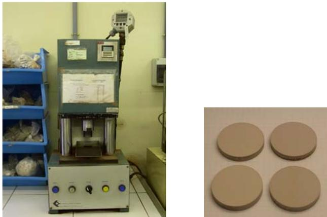
**Figura 4.6** *Izquierda: Prensa de laboratorio. Derecha: Probetas prensadas.*
