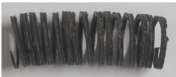
Figura 7.59.- Aspecto de la rosca tras la rotura mecánica o extracción
