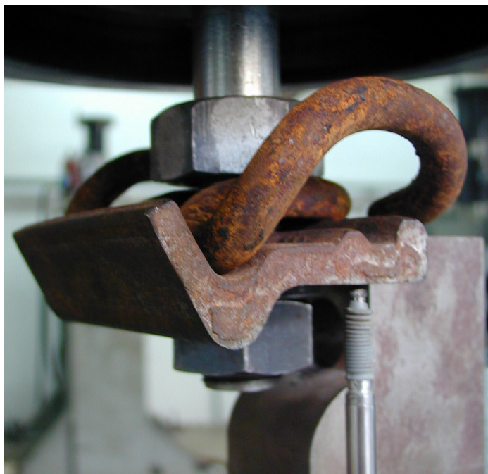
Figura 7.81.- Ensayo de elasticidad realizado sobre el clip tipo A introducido en cámara climática 300 h sin recubrimiento
