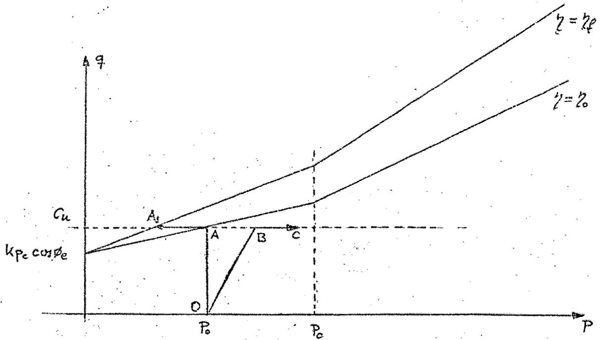
Fig 2.3.- Criterios de plastificación inicial y de rotura en efectivas.
