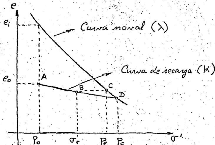
Fig 2.2.- Ensayo de compresión isotrópica.
