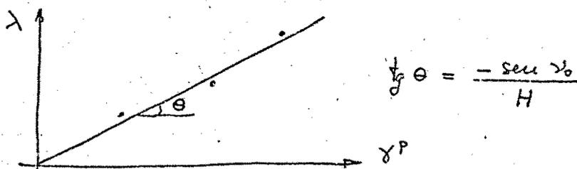
Fig 2.7.- Obtención de  $\nu_0$  en cada ensayo.
