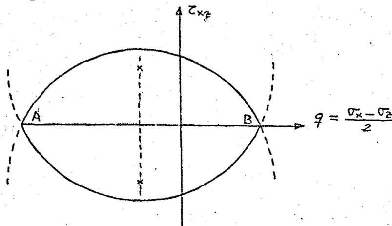
Fig 2.1.- Criterio de rotura en totales
