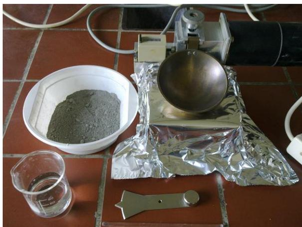
Figura 5.6 – Materiales y equipo utilizados en el ensayo del límite líquido de Atterberg
