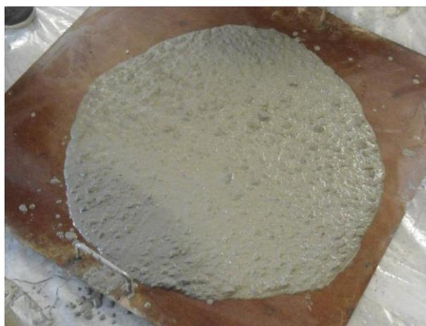
Figura 7.18 – Ensayo de escurrimiento del hormigón autocompactante con áridos reciclados
