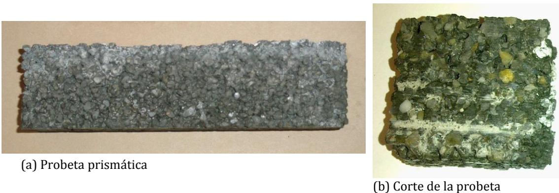
Figura 7.23 – Probeta prismática de mortero poroso (a) y corte de la probeta (b)
