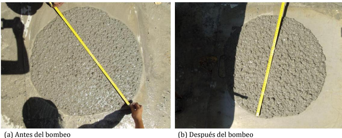
*Figura 7.8 – Escurrimiento del HLACF producido en la planta de hormigón preparado*
