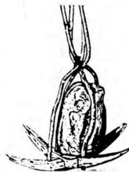
Fig. 4.3.- Ancores marines. Les més antigues, dels pobles que desconeixen els metalls, son una combinació de pedres toves i rusta. Les mes modernes son d'acer i estan dissenyades perque penetrin en profunditat i obtinguin un rendiment alt.
