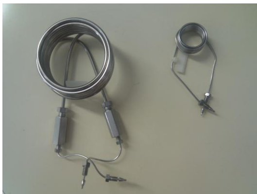
Figura 2.4. Loops de 5 y 1 mL del Symbiosis Pico™ utilizados para cargar la muestra en los cartuchos de extracción on-line.
