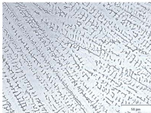
Fig. 1.18- Micrografia mode solidificació [FA] mostrant ferrita de morfologia esquelètica [27]
