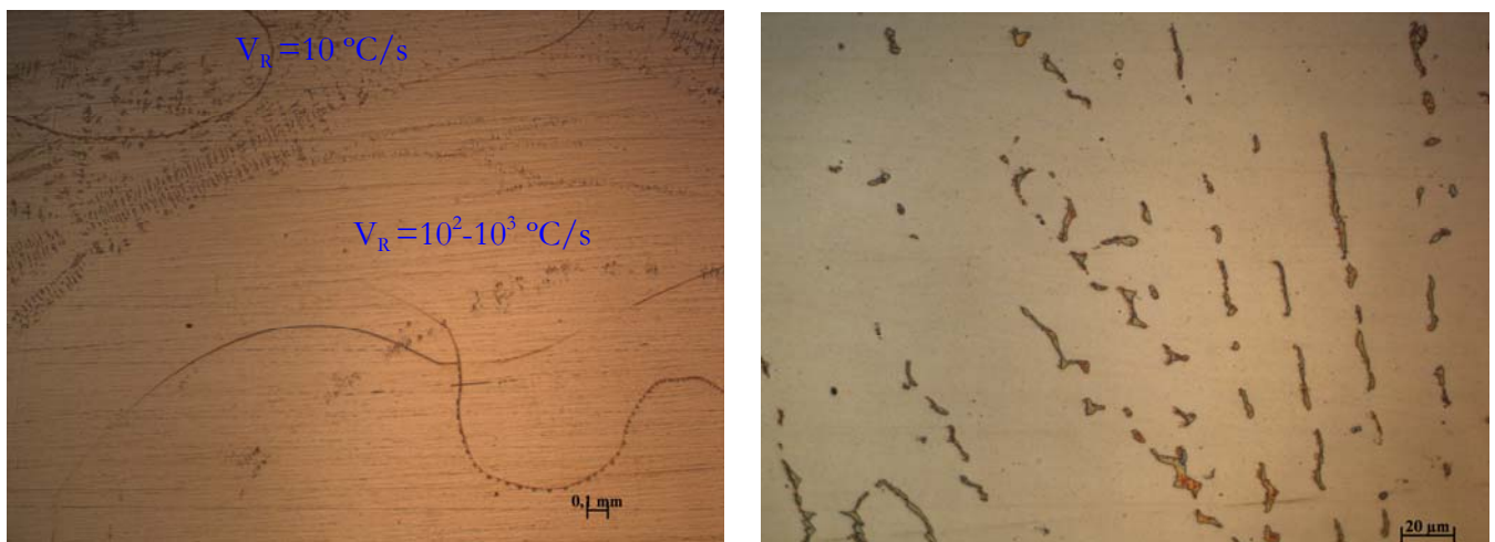
Fig. 3.49-(a) Micrografia de la mostra A21 refosa - (b) Detall de ferrita eutèctica a la zona refredada a 10 °C/s de la micrografia (a) .
