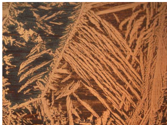
Fig. 3.44- Atac ferrofluid EMG 911 sobre mostra A02 amb mode de solidificació [F].
