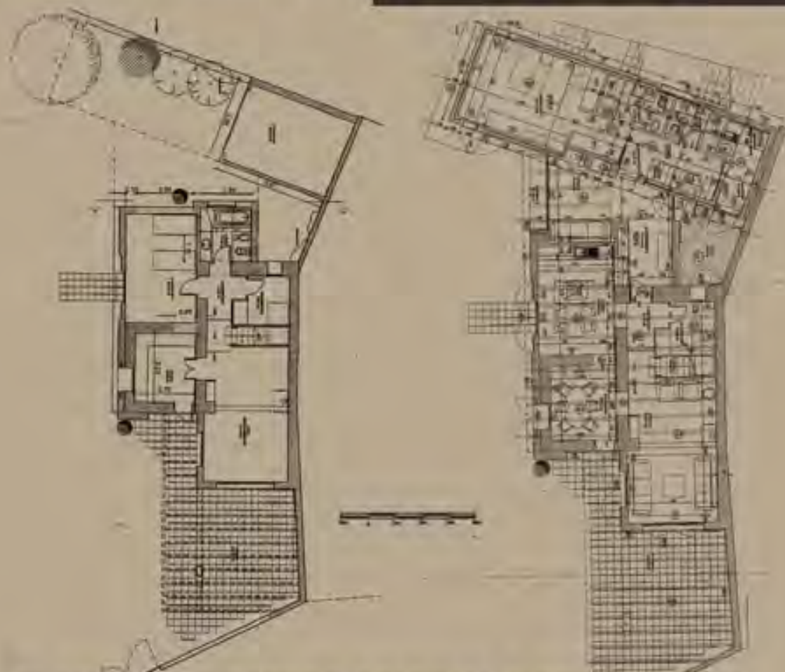
PLANTA BAJA ESTADO ORIGINAL Y ESTADO FINAL
