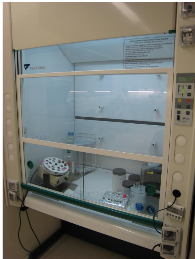
Fig. 26. Hotte aspirante pour la manipulation de l'osmium
