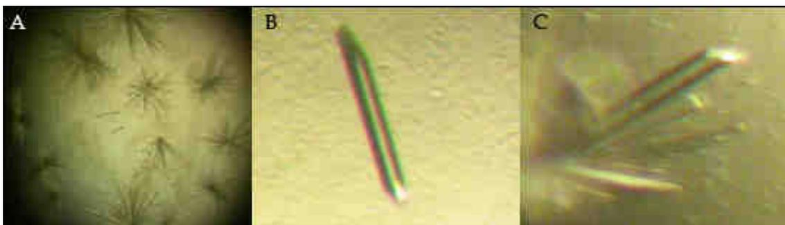
**Fig.20 Cristales de MCD SeMet triclinicos.** (A) Cristales iniciales de MCD SeMet. (B) y (C) Cristales de MCD SeMet después de optimizar (Dimensiones aproximadas: 0.025x0.05x0.2 mm)
