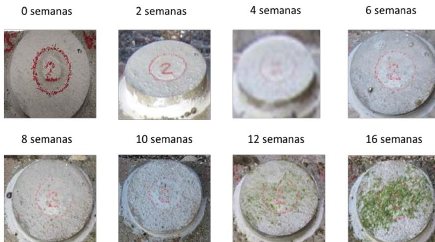
Figura 6.4.- Evolución de la superficie de las probetas no tratadas con acabado semi-rugoso
