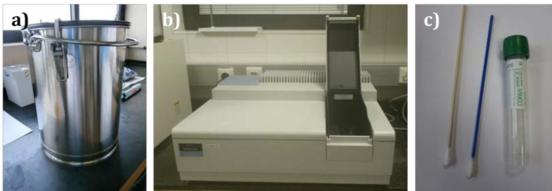
Figura 3.18.- Equipos empleados en el estudio: a) cámara estanca, b) espectrofotómetro UV-visible y c) hisopo para recuperación del cultivo.
