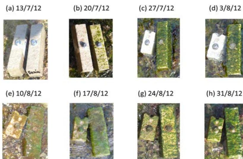
Figura 6.12.- Evolución de la superficie de las probetas durante el segundo ensayo (izquierda, probeta tratada; derecha, probeta sin tratar)
