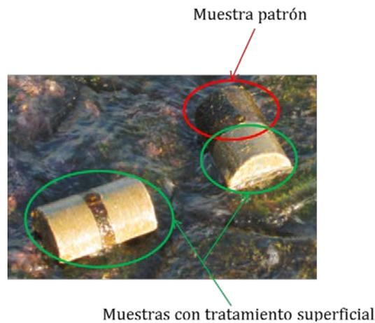
Figura 8.1.- Probetas de hormigón con y sin tratamiento superficial situadas en el puerto de Barcelona.
