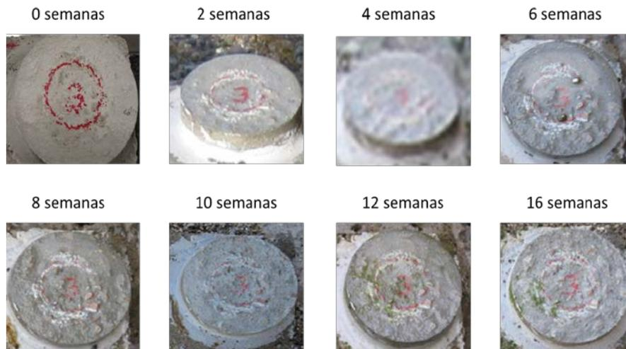
Figura 6.5.- Evolución de la superficie de las probetas no tratadas con acabado rugoso
