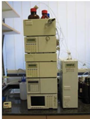
Figura 3.16.- Detalle del equipo de HPLC
