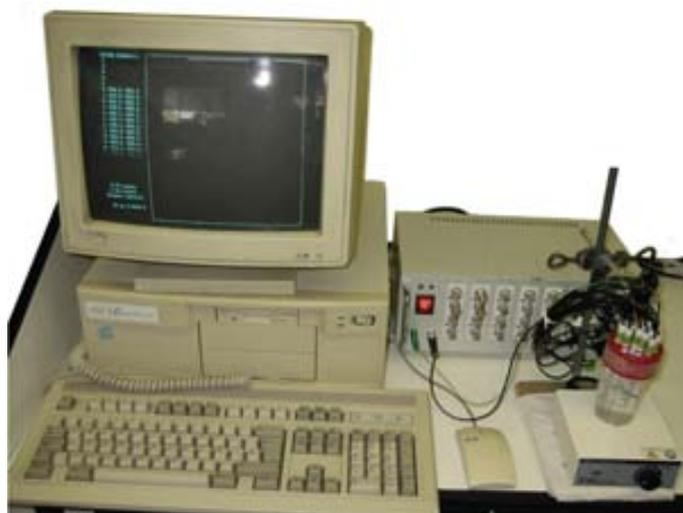
**Figura 3.4.** Fotografía del sistema de medición potenciométrica.
