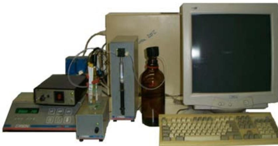
**Figura 3.6.** Fotografía del valorador automático.
