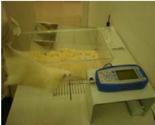
Figura 5. Rata al ser evaluada usando el dispositivo de grip test .
