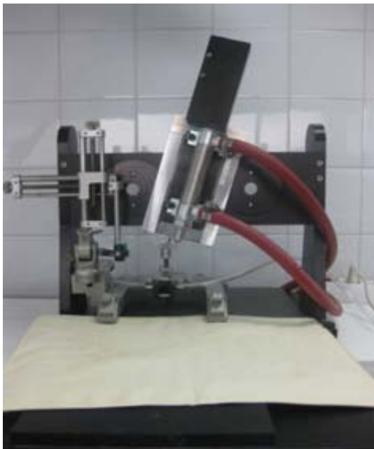
Figura 2. Dispositivo de impacto cortical controlado.
