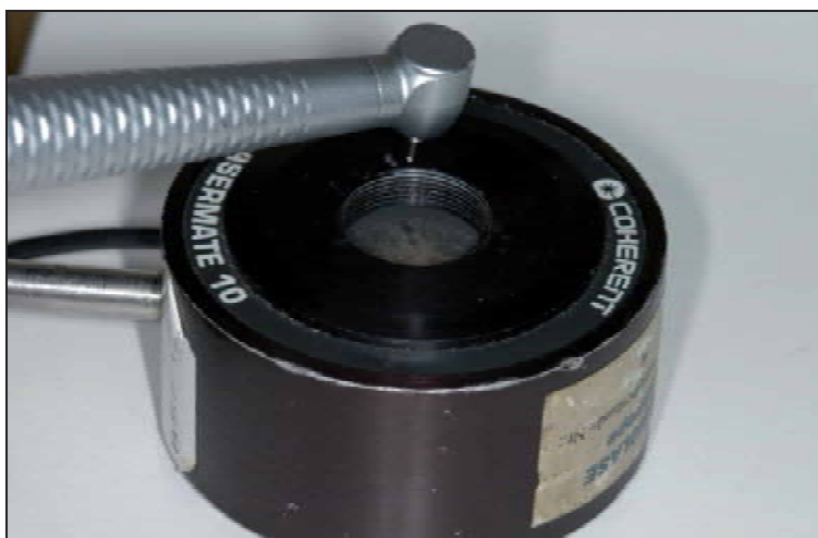
Figura 59. Medición de la potencia real en el extremo del “tip”.
