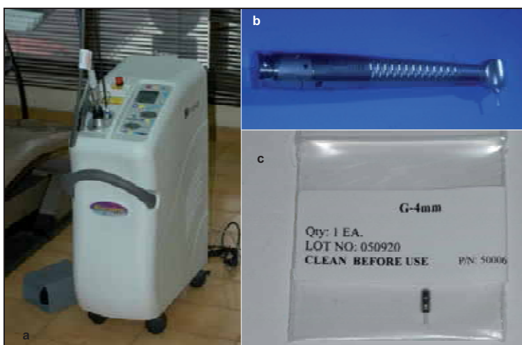
Figura 53. a- Fotografía del sistema láser utilizado. b- Pieza de mano. c- “Tip” G-4 mm
