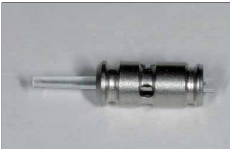
Figura 55. Fotografía de un “tip” G-4 mm. Obsérvese la ligera conicidad de dicho “tip”.
