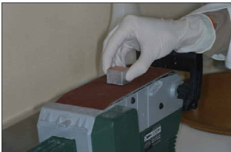
Figura 71. Lijadora utilizada para obtener barrillo dentinario en las muestras.
