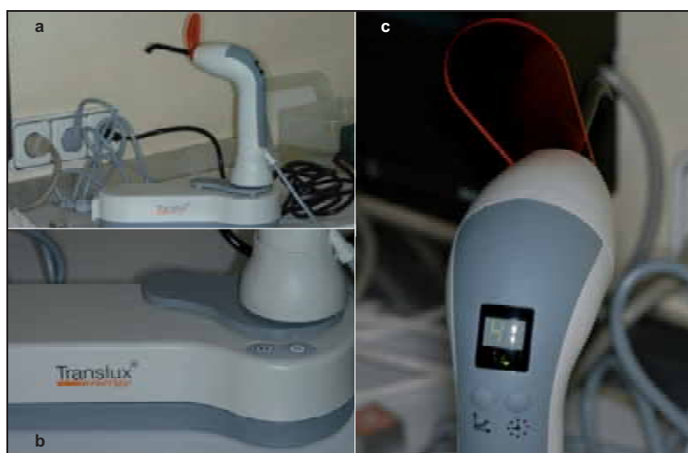
Figura 74. Lámpara halógena para la polimerización de los materiales. a- Vista lateral, b- base de la unidad, c- modo exponencial.
