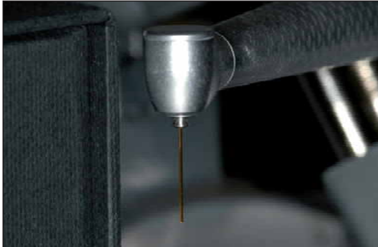
Figura 63. Comprobación de la perpendicularidad del “tip”.
