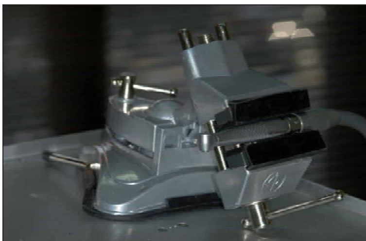
Figura 62. Sujeción de la pieza de mano para el cálculo del diámetro del impacto.
