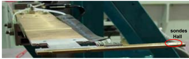
Figura 3.46: Braç amb el capçal de les sondes Hall.
