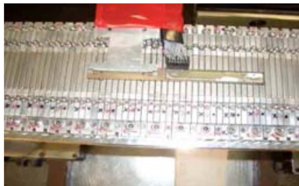
Figura 10.13: Imatge del moviment del banc Hall sobre l'ondulador. Els punts, creus i fletxes negres situats a un lateral dels capçals dels triplets corresponen a la direcció de la imantació de cada bloc.
