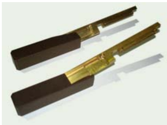
Figura 3.53: Peces de baquelita dissenyades per posar el capçal inclinat a dins de l'imant de calibratge.
