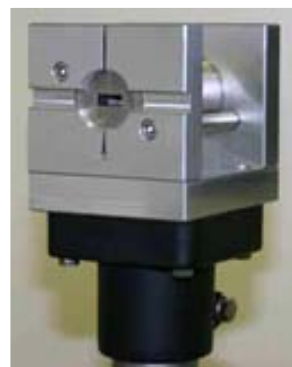
Figura 3.42: Cambra de buit magnètic del laboratori de mesures magnètiques del sincrotró Alba.
