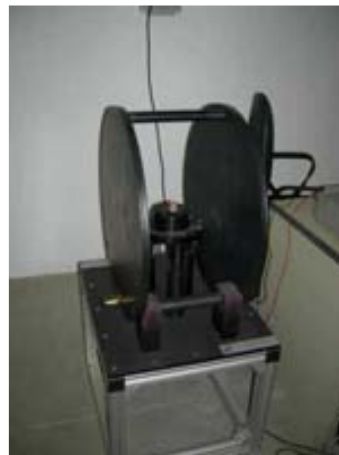
Figura 3.2: Sistema de bobines Helmholtz del sincrotró Alba.
