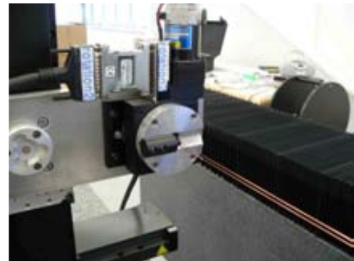
Figura 3.36: Detall del fil basculant del laboratori de mesures magnètiques al sincrotró Alba.
