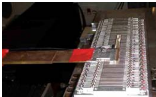
Figura 10.12: Imatge del braç del banc Hall mesurant el camp local a l'eix de l'ondulador.
