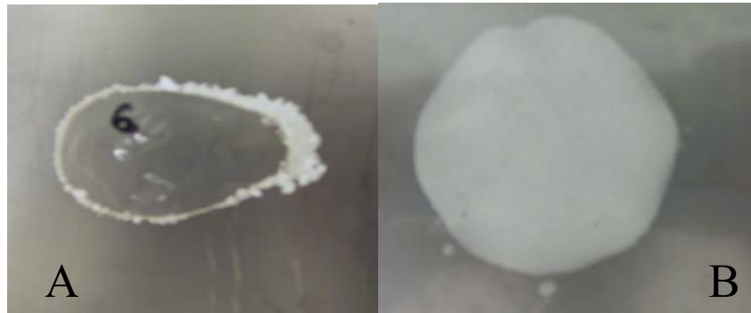
Figura 10: Exemples experimentals de làmines obtingudes amb la premsa “Carver”. La figura A mostra un film de HPMC mentre que la figura B és un exemple d'un Gelucire 50/13
