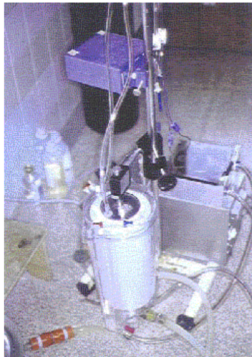
Figura 11: Equipo de circulación extracorpórea (bomba de bypass cardiopulmonar): Bomba, oxigenador e intercambiador de calor.
