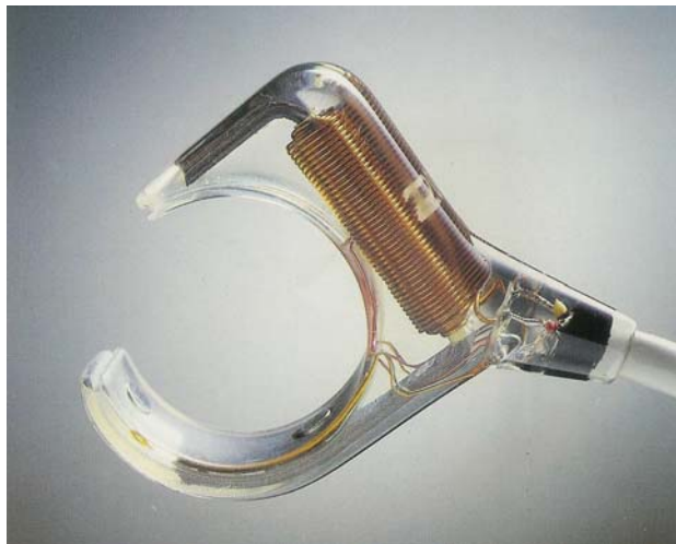
Figura 5. Sonda electromagnética de medición de flujo.
