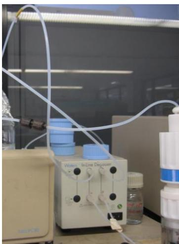
**Fig 4.6:** Desgasificador del HPLC.
