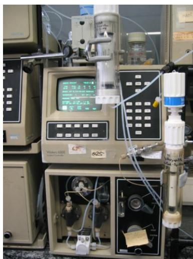
**Fig 4.7:** Bomba del HPLC.
