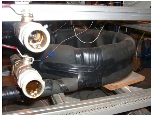
Figura 6.17.- Intercambiador de calor de tubos concéntricos en espiral.
