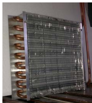
Figura 6.34.- Intercambiador de tubo con aletas herringbone estudiado.
