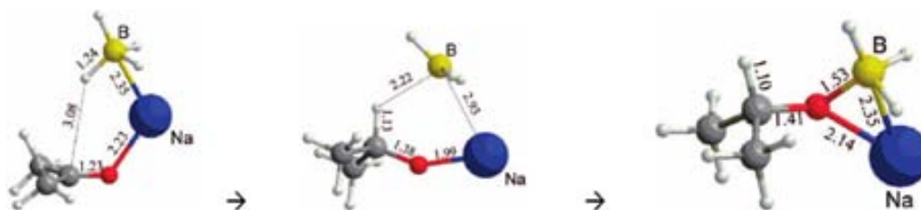
Esquema 3.4. Estructures dels reactius, l'estat de transició i el producte de la reducció de l'acetona amb \text{NaBH}_4 .
