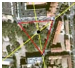
Figura 3.7. Construcción del incentro de un parque de Huesca
