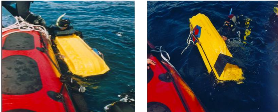
Figura 3.12. Fondeo del correntímetro en el emisario de Gandía.
