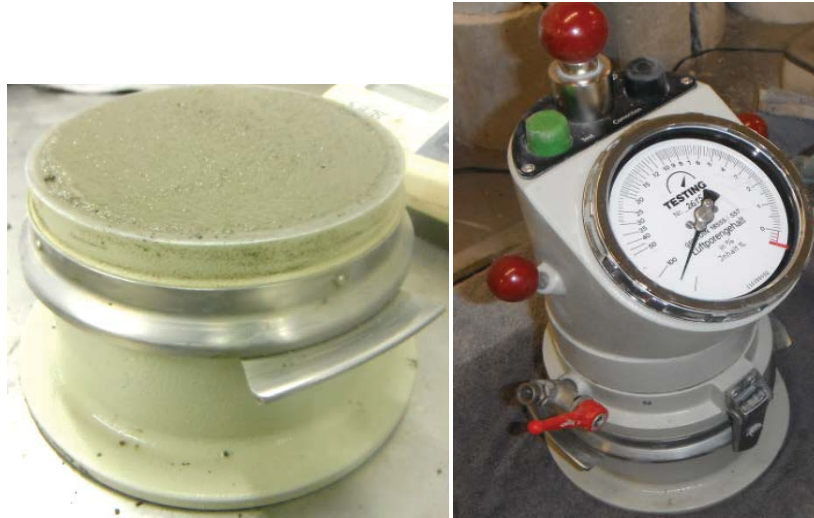
Figura 5.7: Muestra de mortero y aparato medidor de aire ocluido
