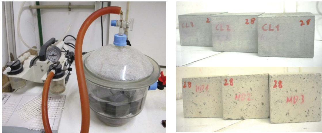
Figura 5.8: Vista general del proceso de saturación de las muestras en vacío y aspecto de las muestras de pasta y mortero secas.
