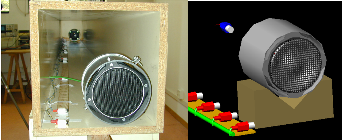
Fig. 9.2 Fotografía (sin tapa) y dibujo del altavoz primario situado en el extremo del encapsulamiento.
