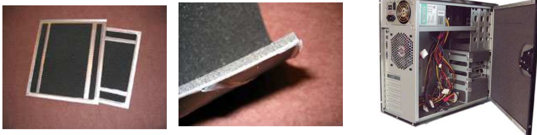
Fig. 13.2 Fotografía de capa de tejido utilizado para evitar la resonancia en el interior del encapsulamiento. Fuente: QuietPC.
