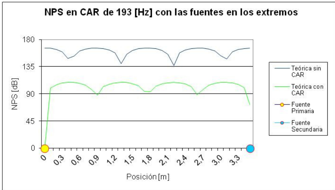
Fig. 7.27 Control activo teórico a la frecuencia de resonancia 193 [Hz] con d_1 = 0 [m] y d_2 = L = 2\lambda = 3,554 [m] con micrófono de error en x = 0 [m]. (Longitud del tubo: 3,554 m).
