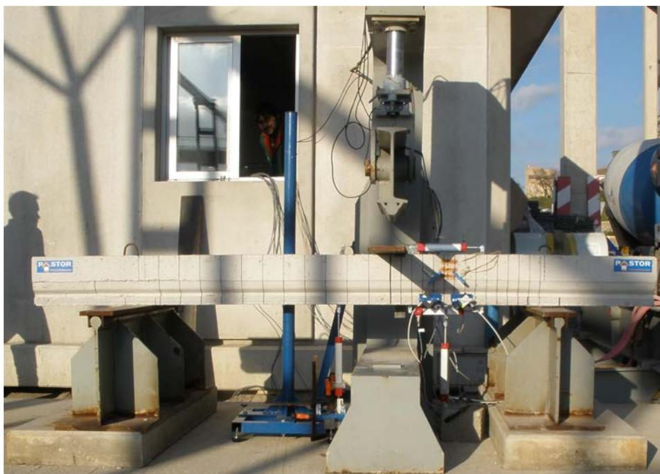
Figura 4.19: Ejemplo de configuración de ensayo. Ensayo 24-T3-T12-SCC.
