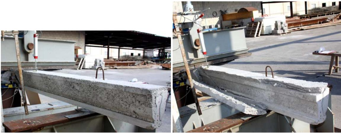
Figura 5.1: Imágenes, previa y posterior al ensayo, que muestran el incorrecto vibrado del hormigón in situ de la viga 24-T5-T20-SCC [112].
