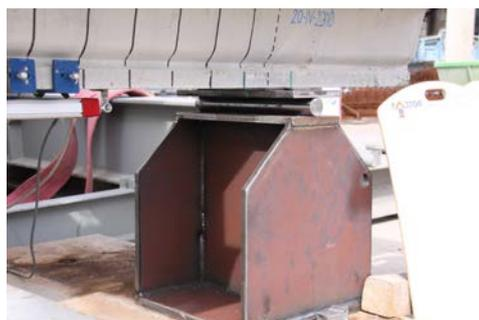
Figura 4.20: Apoyo deslizante utilizado en los 12 últimos ensayos.
