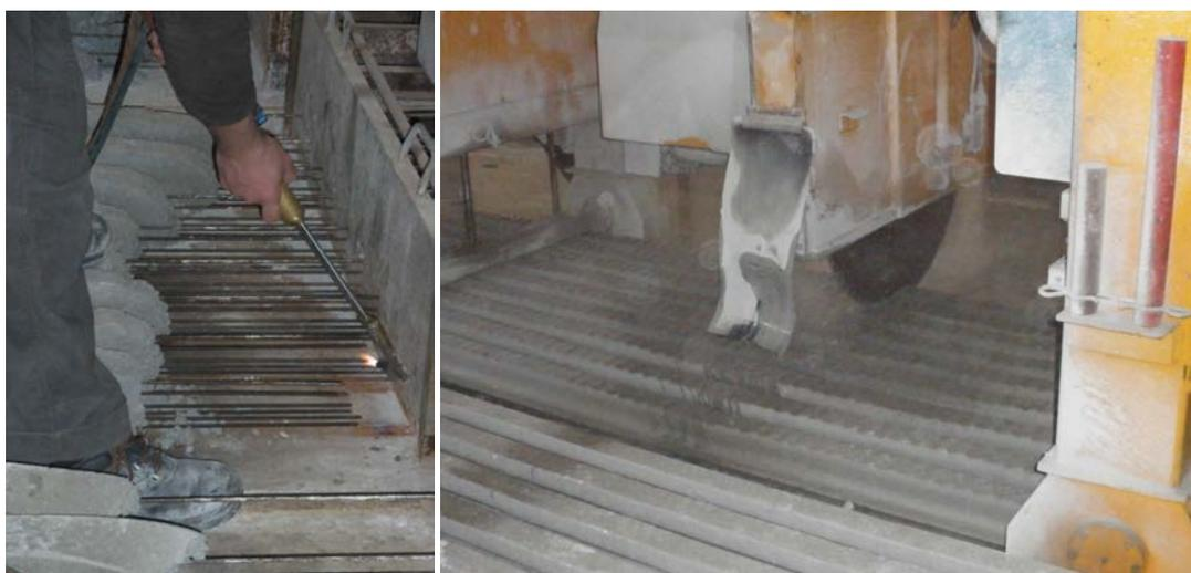
Figura 4.15: Proceso de transmisión de pretensado y cortado de viguetas.
