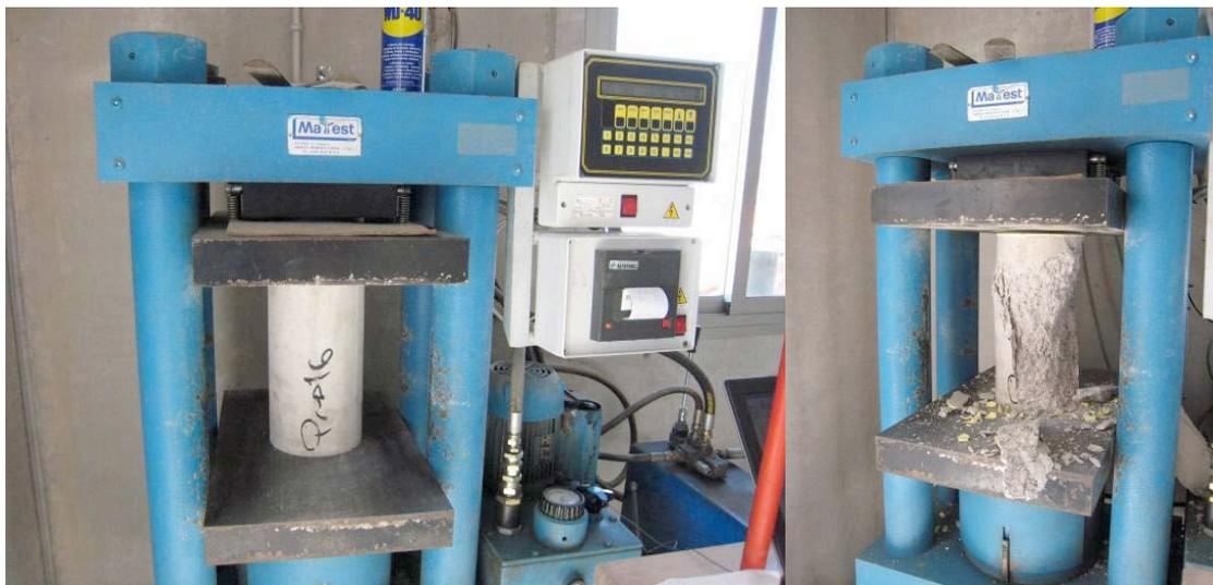
Figura 4.3: Rotura de probetas a compresión, realizadas justo antes de los ensayos.
