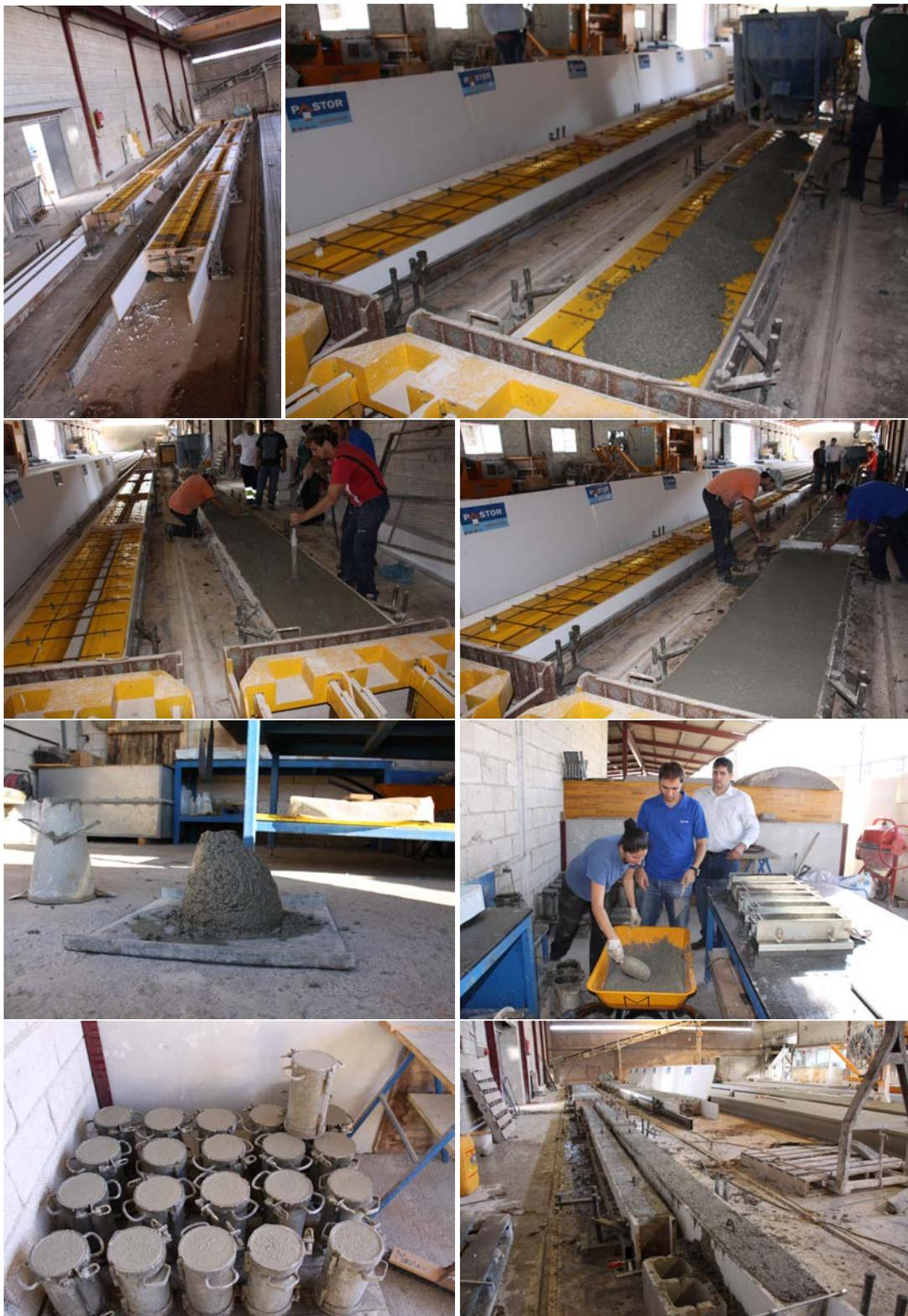
Figura 4.16: Proceso de hormigonado de capas de compresión de semiviguetas T-12 y sus probetas.
