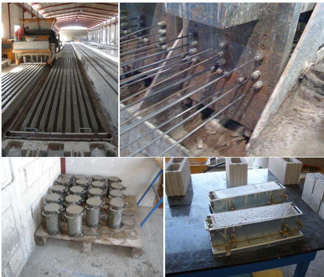
Figura 4.14: Proceso fabricación de: semiviguetas T-12, viguetas autorresistentes T-20, y sus probetas.
