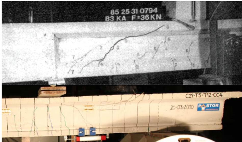
Figura 5.5: Comparación de fisuración ensayos de Kotsovos de elementos de sección en T sin armadura a cortante [50] con ensayo 29-T5-T12-CC4. Adaptada de [112].
