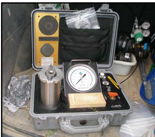
Figura IV.25. Fotografía de la cámara de presión
