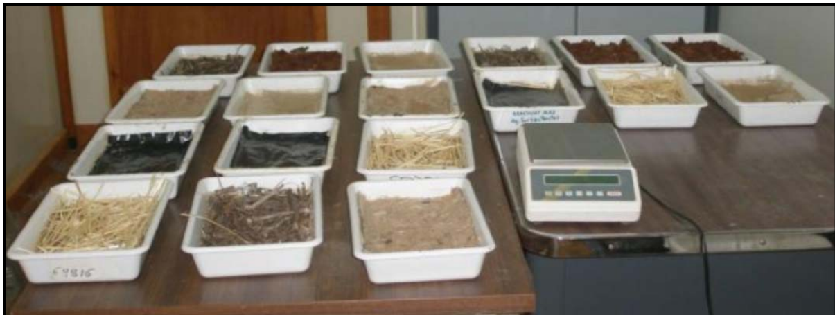
Figura III.1. Fotografía del ensayo preliminar de medida de la evaporación del suelo desnudo y sujeto a cinco acolchados en condiciones de laboratorio.
