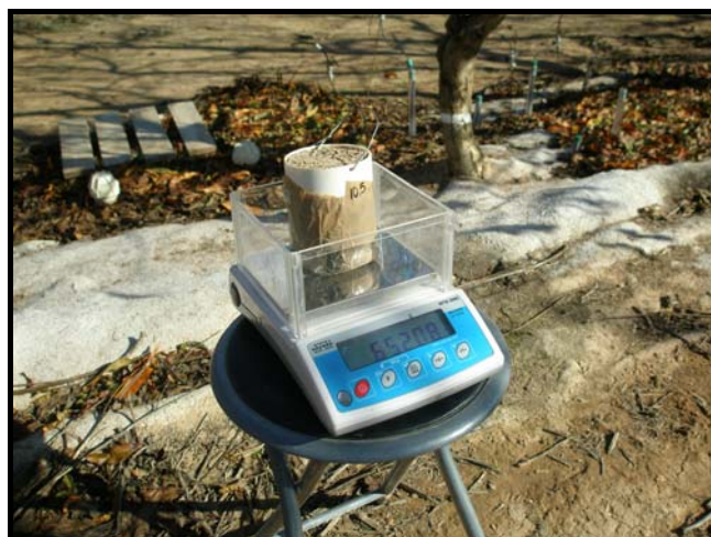
Figura IV.11. Balanza portátil para la pesada de los ML en el ensayo de evaporación.
