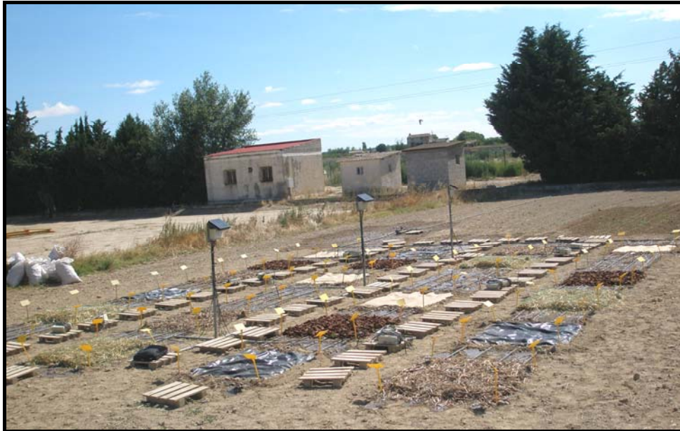
Figura III.5. Vista general del ensayo de evaporación en campo. En el pasillo central se observan los tres soportes con placa solar de los datalogger Microlsis.
