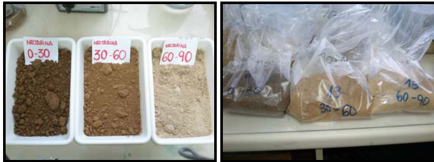
Figura IV.5. Fotos de las muestras de suelo recogidas en la parcela experimental del ensayo de acolchado en nectarina.
