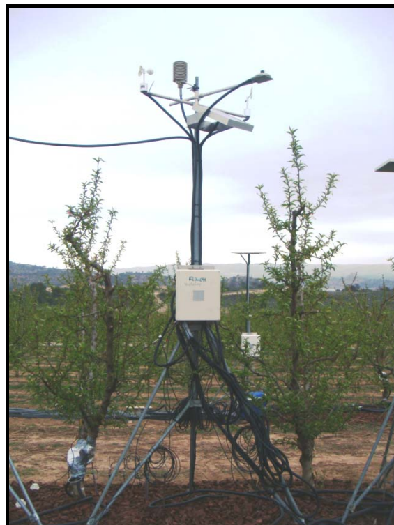
Figura IV.4. Foto de la estación meteorológica instalada en el ensayo de acolchado de nectarina.
