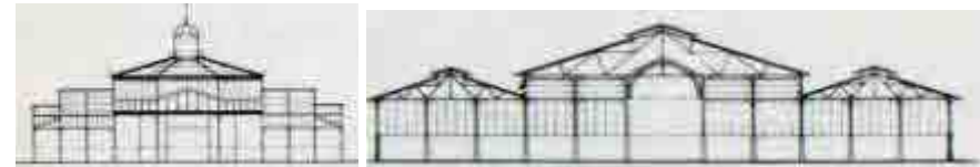
Fig. 192 Secciones transversales, central y lateral respectivamente.
