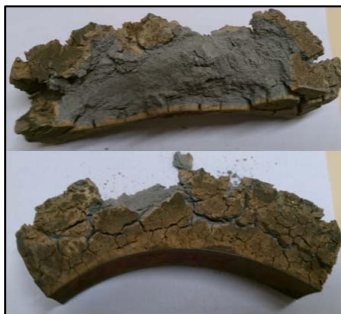
Figura 5.20 Daños sufridos por las probetas curadas al aire a 56 días.
