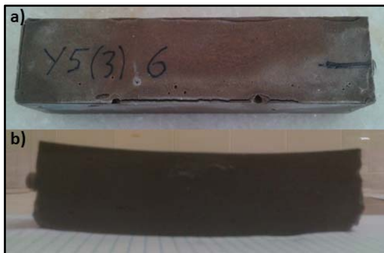
Figura 5.5 a) sistema 85/15 con 5% de C\bar{S} a 10 meses al aire. b) sistema 85/15 con 5% de C\bar{S} a 10 meses sumergida.
