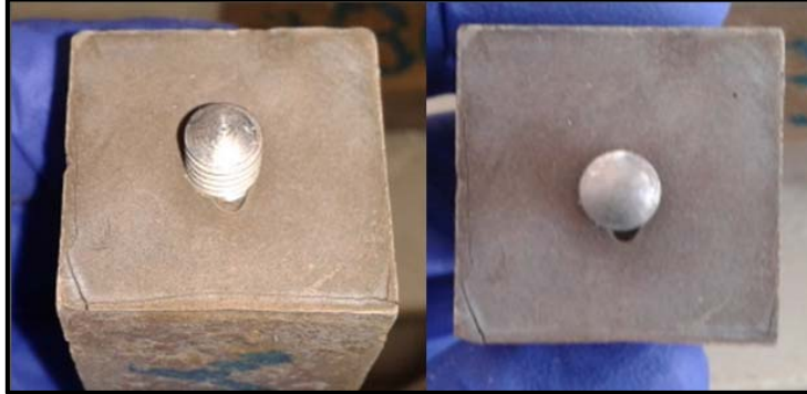
Figura 5.3 Fisura en aristas para el sistema 85/15 con 3% C\bar{S} a 12 meses al aire.
