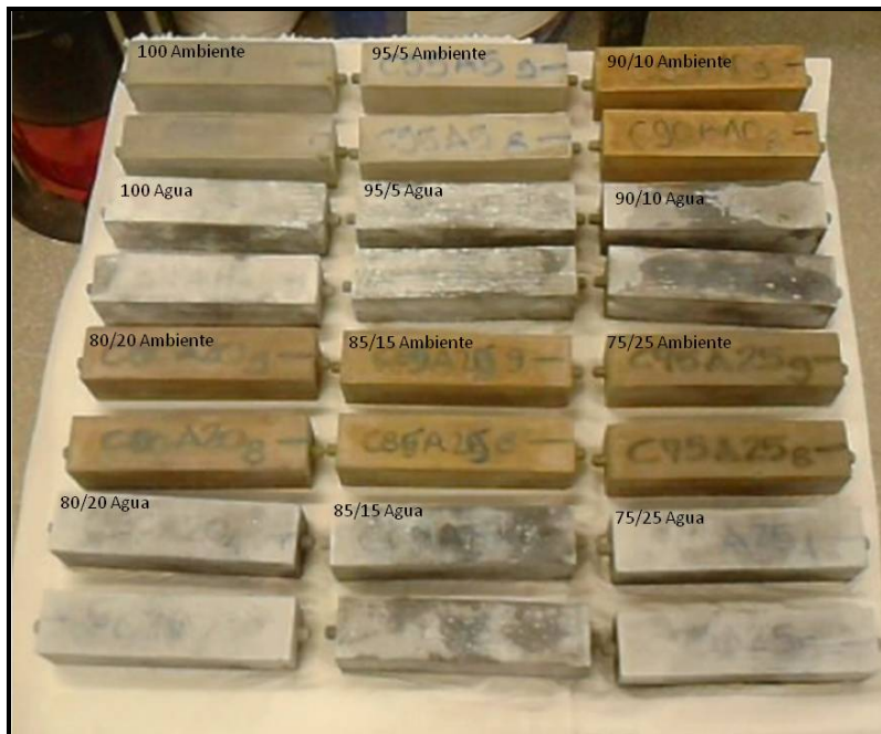
Figura 3.7 Probetas de pasta realizadas para las composiciones con 0% C \bar{S} a la edad de 1 año.
