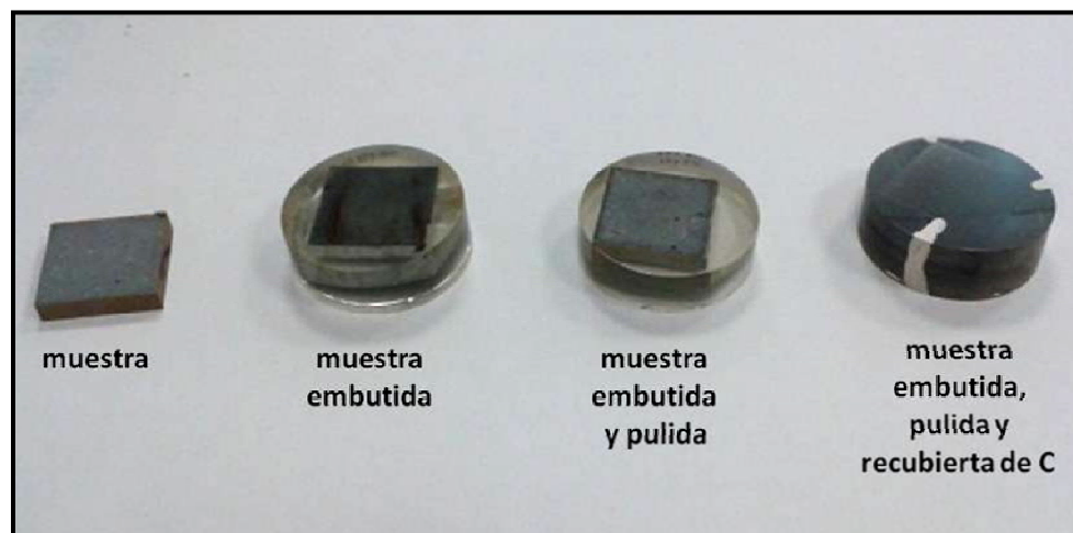
Figura 3.10 Pasos en la preparación de la muestra para microscopía electrónica.
