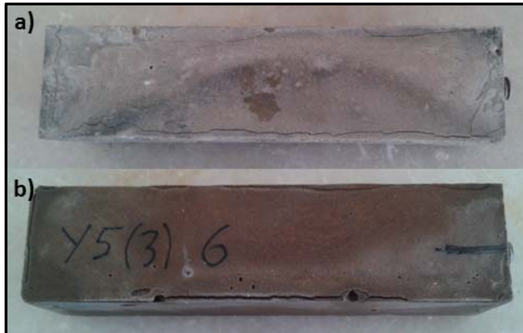
Figura 5.4 a) sistema 95/5 con 5% C\bar{S} a 10 meses al aire. b) sistema 85/15 con 5% de C\bar{S} a 10 meses al aire.
