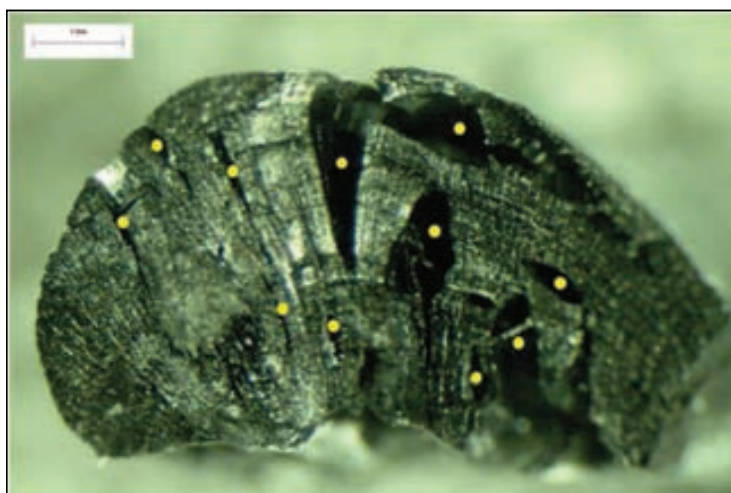
Figura 11: Cuantificación de grietas sobre el plano transversal del carbón (carbón experimental)
