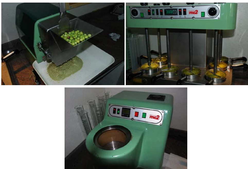
Figura 3.4. Extracción del aceite de oliva mediante el sistema Abencor
