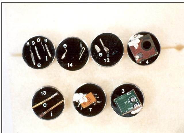
**Figura 104.** Probetas – 3, 4, 7 y 8, 9, 12, 13 y 14 externo/interno- montadas para el análisis de SEM y EDS
