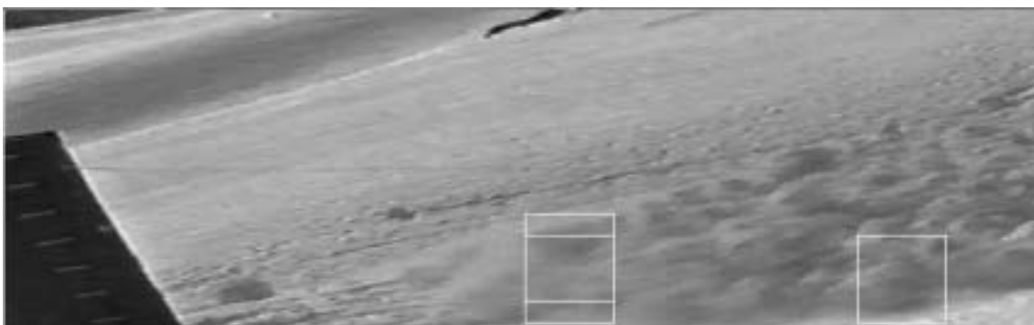
Image 4-20. Image, détramé, de l'avalanche du 15 Janvier 92. Nous pouvons apprécier 3 des 40 sous-fenêtres (1, 21 et 40) utilisées pour faire les calculs de la vitesse superficielle de l'avalanche.
