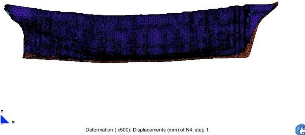
Figura 270. Deformada por ola 90°. Vista lateral.
