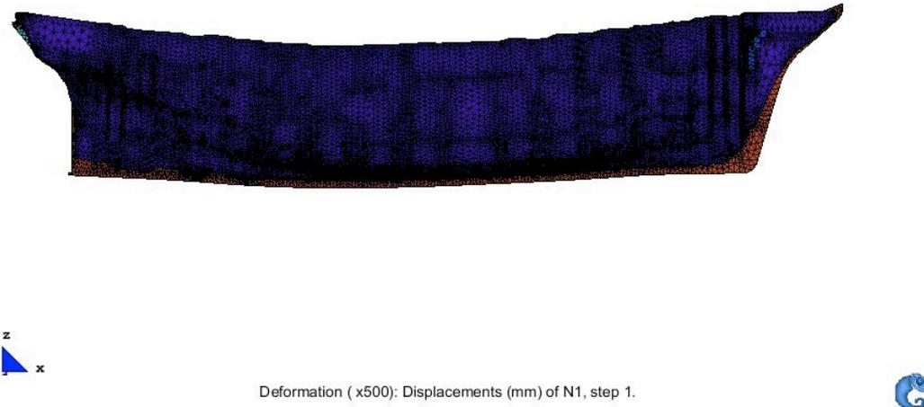
Figura 267. Deformada. Mar plana. Vista lateral.
