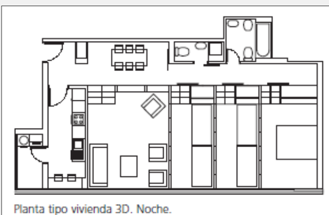
Figura 87: Plantas de las viviendas con posibilidad de tener 3 habitaciones donde se muestra el potencial uso de los espacios, de día y de noche, según el movimiento de las paredes y las camas. La vivienda de día no se muestra amueblada
