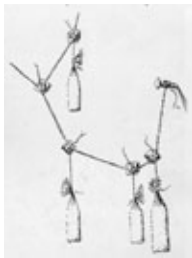
(GRAF.2: 131) Método para aplicar las cargas al modelo colgante (Escala del peso 1:10.000) 118 .
