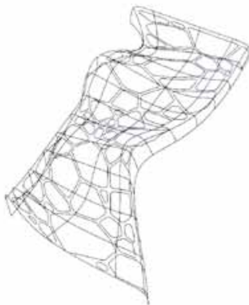
35. Reiser e Umemoto, solaio con geometria voronoi Alishan Mountain Railway, Taiwan, 2005 il solaio in cemento armato con geometria voronoi forma il tetto della stazione dei treni.
