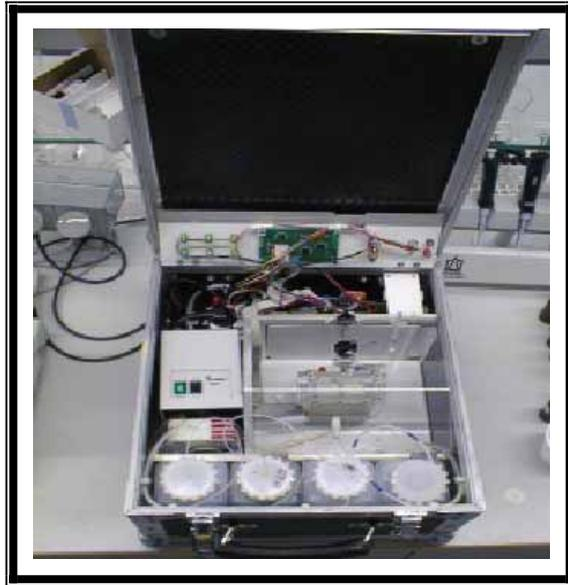
**Figura 5.5.** Prototipo islandés de FIA para el análisis de muestras in situ.
