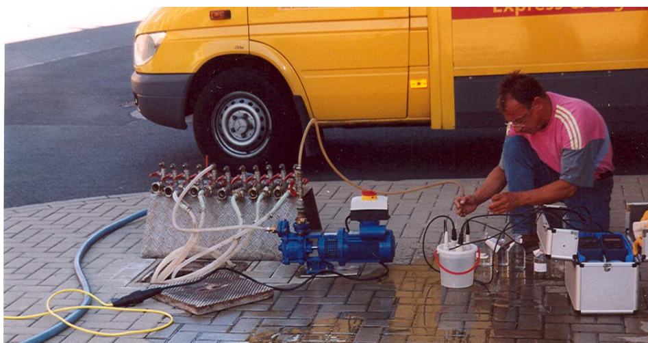
Figura 17.-Presa de mostres d'aigua subterrània a diferents fondàries a un pou multinivell a Düsseldorf (Alemanya).
