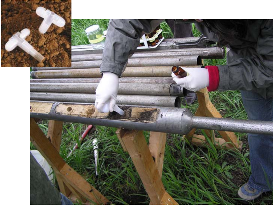
Figura 22.-Presca de mostres de sòl amb el mostrejador Terra Core.
