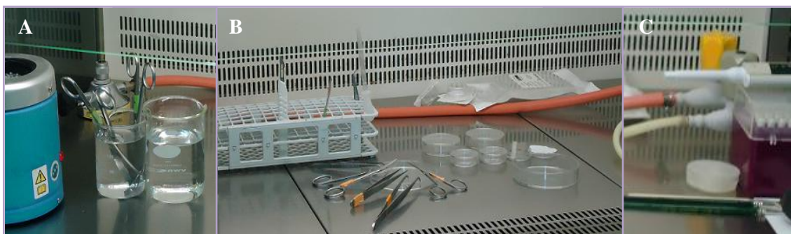
Figura 9. Material para la realización de cultivos organotípicos. A, Esterilizador y vasos de precipitados con etanol al 70% (para la descontaminación de las tijeras) y agua destilada. B, Bisturí, tijeras, pinzas y placas de Petri de distintos tamaños. C, Pinceles, micropipeta y puntas.
