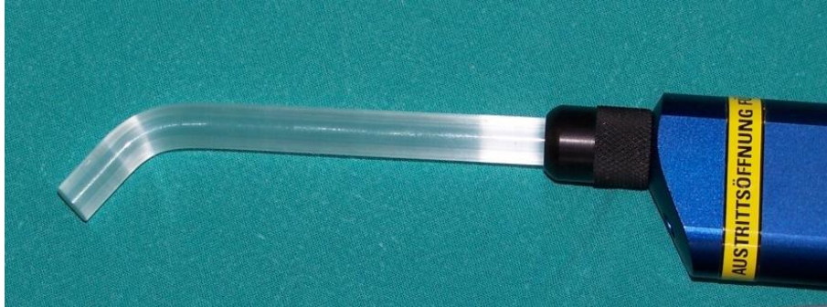
Figura 22 - Fibra óptica: fibra de vidrio de 0,7cm.
