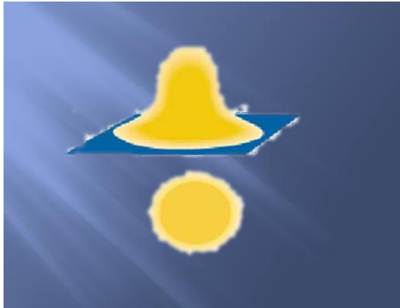
Figura 15 - Distribución Gaussiana del haz de láser (TEM 00).
