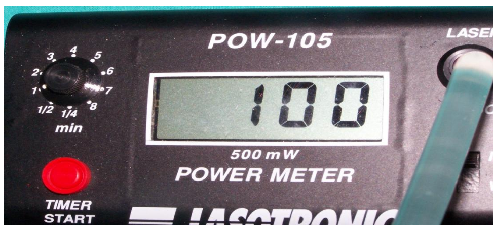
Figura 26 - Comprobación de la potencia real de salida.
