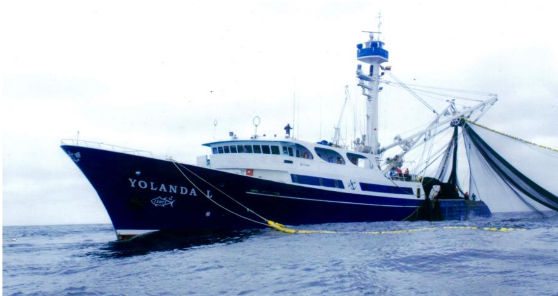
Foto 8: Buque atunero >24 metros de eslora, sujeto a las disposiciones del Acuerdo de Ciudad del Cabo de 2012 sobre la implantación de las disposiciones del Protocolo y Convenio de Torremolinos relativos a la seguridad de los buques pesqueros. Fuente: International Seafood Sustainability Foundation (ISSF)
