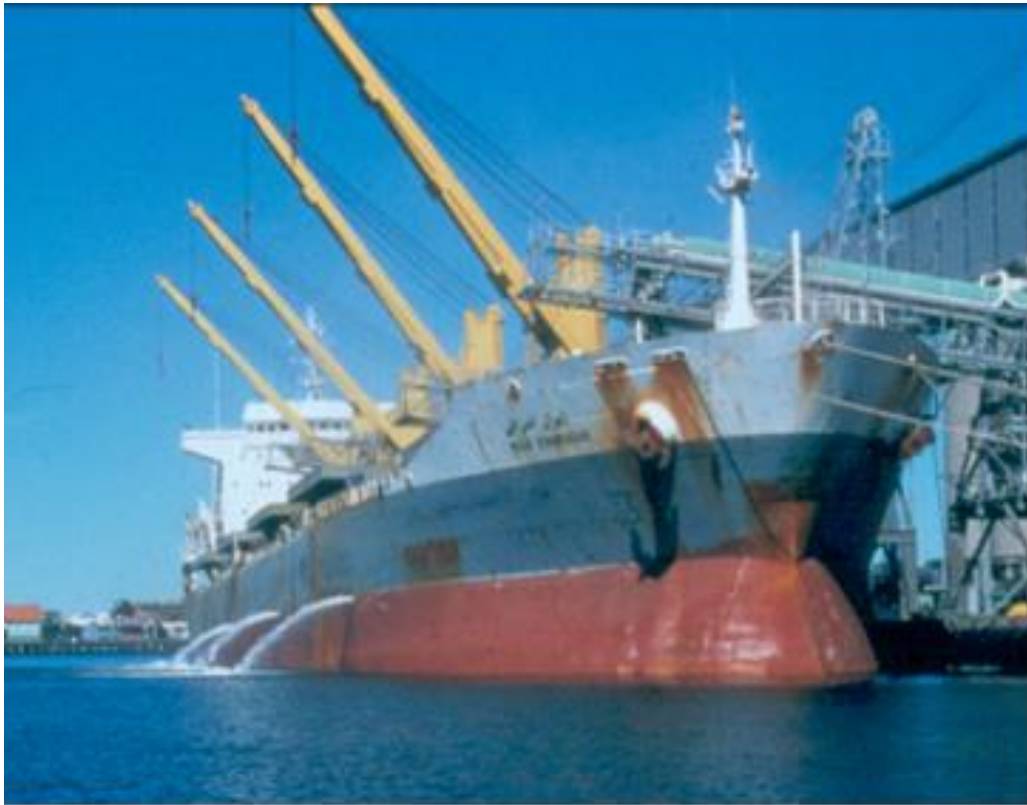
Foto 6: Descarga de agua de lastre por gravedad. Fuente: Global Ballast Water Management Programme (GloBallast)
