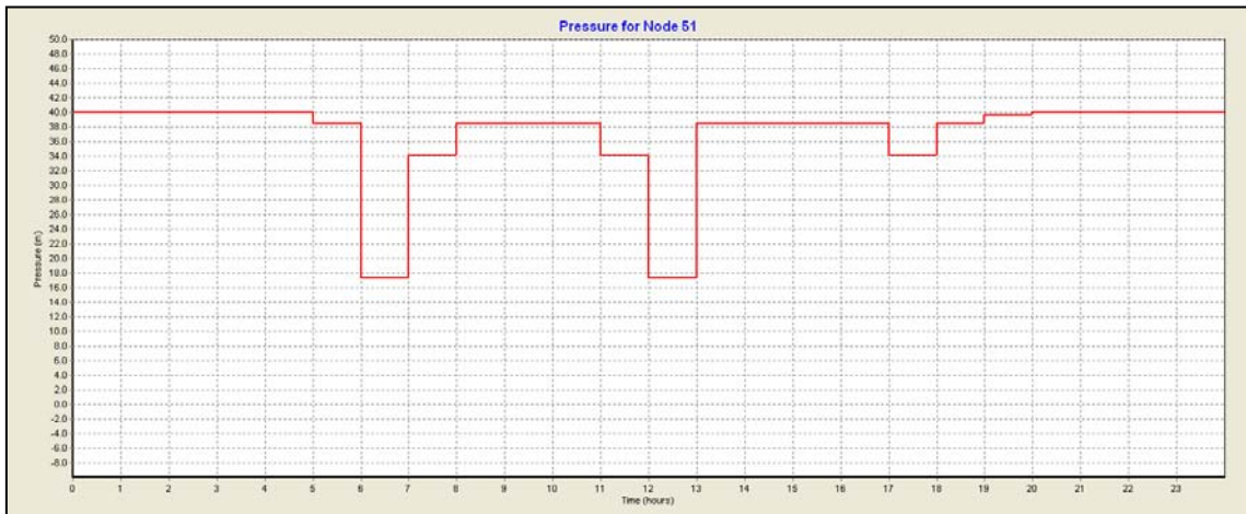
Figura 141. Representación presión en nodo 51 después de incrementar diámetro tubería 34 a 100m. . Fuente: elaboración propia
