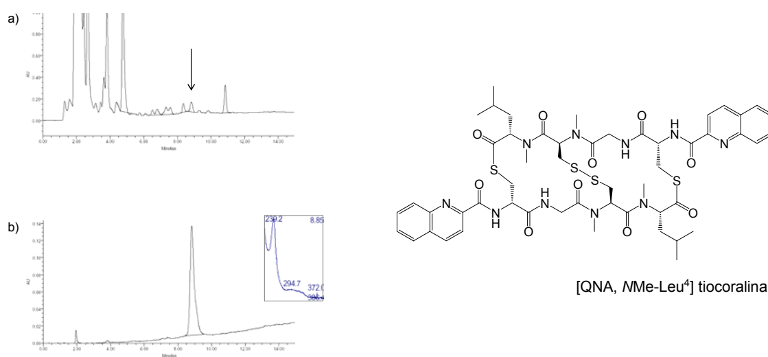
Figura 3.44 Anàlisi per HPLC de a) cru de reacció de la incorporació de l'àcid quinàldic i b) producte purificat en un sistema HPLC analític. Espectre UV i estructura del segon derivat de tiocoralina. Condicions HPLC: gradient de 5:5 a 0:10 en 15 min (H 2 O amb 0.045 % TFA : MeCN amb 0.036 % TFA)
